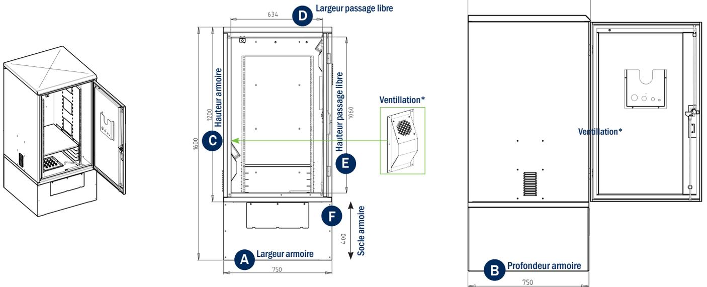
\*Ventilation mécanique par ventilateur et thermostat
